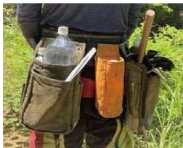
写真 2.4 腰袋のペットボトルによる危険な燃料缶
